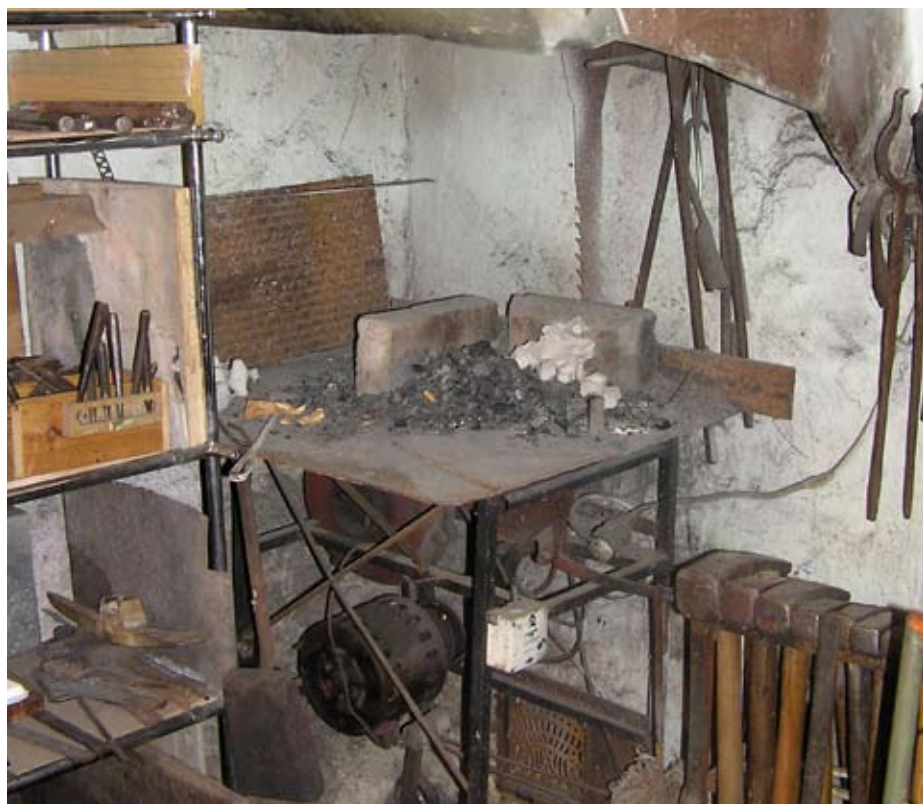
Peč za segrevanje kovine, ki jo poganja električni motor.
